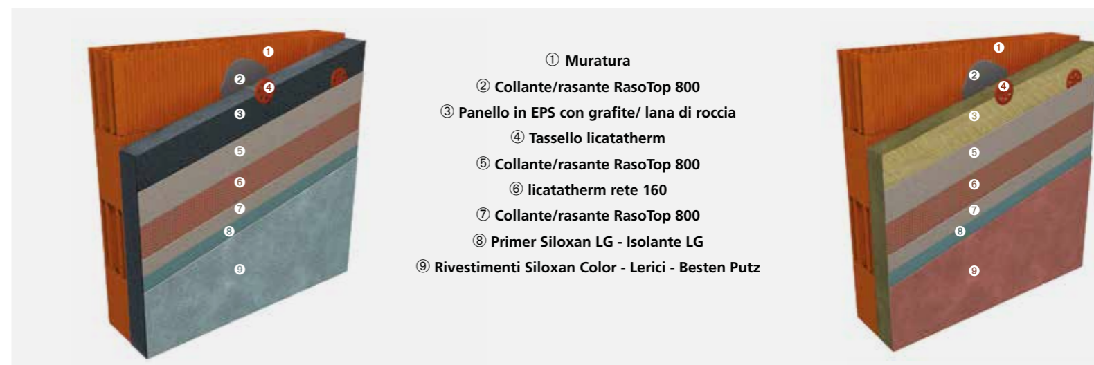
licataTHERM ® EPS Grey Pannello termoisolante in polistirene espanso addizionato con grafite.
